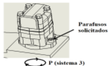
Figura 11. Solicitação dos parafusos da base do motor
